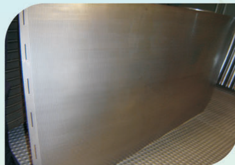
Telas em Inox para Centrífugas Automáticas: Furos Redondos e Cubana
